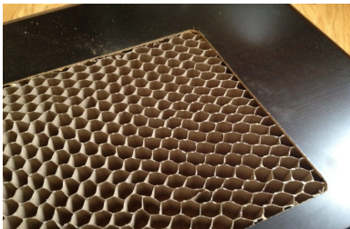
(d) Manufactured honeycomb core
