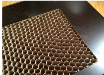
(d) Manufactured honeycomb core
