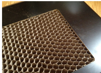
(d) Manufactured honeycomb core
